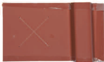
Рисунок 15. Образец после испытания в камере влажности 1000 часов.
