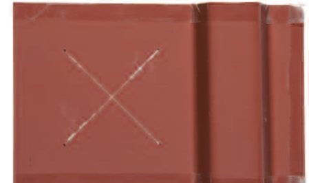
Рисунок 16. Образец после испытания погружением в воду 1000 часов.
