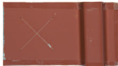
Рисунок 16. Образец после испытания погружением в воду 1000 часов.
