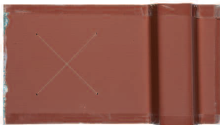
Рисунок 15. Образец после испытания в камере влажности 1000 часов.
