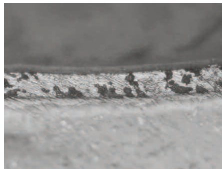
Рисунок 7. Микроструктура Galvalloy® - после коррозии
