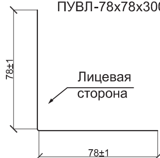
Планка угла внутреннего линейного ПУВЛ-78x78x3000
